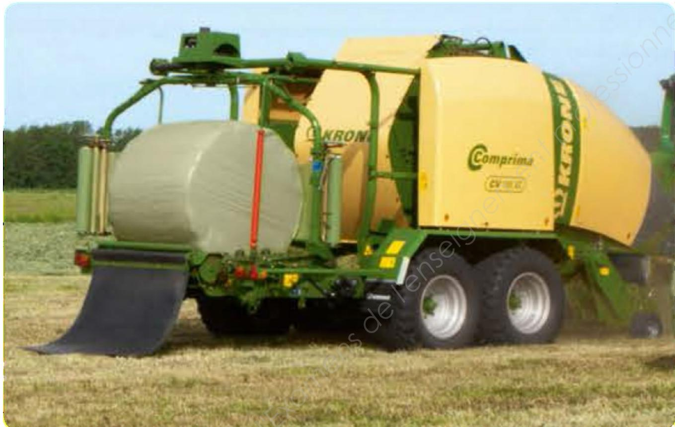
Afin d'assurer un recouvrement correct, la vitesse de rotation de la balle doit être de  $3 \text{ tr}.\text{min}^{-1}$  et la vitesse de rotation d'un bras de  $30 \text{ tr}.\text{min}^{-1}$ .
