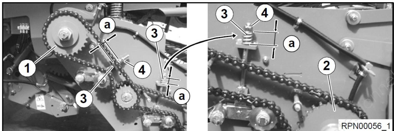
L'entraînement principal du ramasseur (1) et l'entraînement du ramasseur (2) se trouvent sur le ramasseur du côté droit de la machine. Les chaînes d'entraînement sont tendues avec les éléments de serrage (3).
