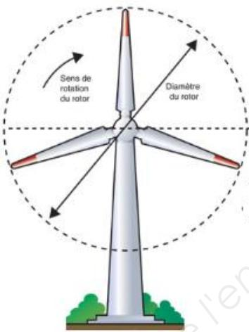
2. La puissance, exprimée en kW, d'une éolienne de ce parc, en fonction de la vitesse  $v$  du vent, exprimée en m/s, est modélisée par la fonction  $P$  définie sur  $[3 ; +\infty[$  par  $P(v) = -55 + \frac{5110}{2+750e^{-0,75v}}$ .
