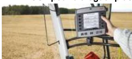
CEMOS, le système d'optimisation des performances de la machine CLAAS, est la réponse de CLAAS aux agriculteurs à la recherche d'un assistant capable de gérer en permanence les réglages de leur moissonneuse en vue d'optimiser ses performances, la qualité de récolte, la sécurité et le débit.
