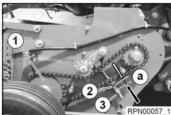
L'entraînement de la vis d'alimentation (1) se trouve sur le ramasseur du côté gauche de la machine.
