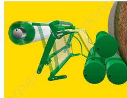
Position de début du liage : durant le pressage, la tôle support de fillet est pratiquement en haut. L'extrême lâche du fillet est maintenue par les dents de la tôle support et dépasse d'environ 20 cm. Le couteau n'est pas encore en position de coupe. Le frein de fillet est serré.
