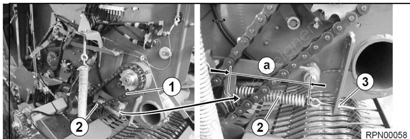
L'entraînement du cylindre de coupe du ramasseur (1) se trouve sur le côté droit de la machine.
